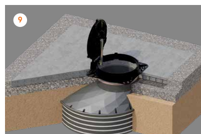
9 Paigaldamisel kontrollida luugi avanemise suunda redeli suhtes.
