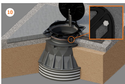
10 Priveržiami ankeravimo varžtai ketinio dangčio montavimo rėmo kampuose
