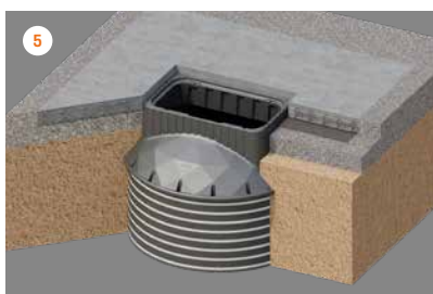
5 Lisada killustikaluse kiht koormusjaotusplaadi ümber.
