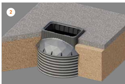
2 Lisada tihendatud killustikaluse kiht.
